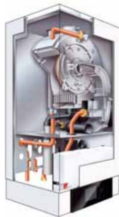
Der Brennwertkessel nutzt im Gegensatz zu klassischen Kesseln die Kondensationswärme des Wasserdampfes in den Abgasen und bietet insofern Nutzungsgradsteigerungen von bis zu 10% bei Gas und bis zu 6% bei Öl. Beim Einsatz in bestehenden Gebäuden ist darauf zu achten, dass eine hinreichend niedrige Rücklauftemperatur des Heizsystems unter 45°C für Heizöl und 55°C für Gas gewährleistet ist. Die Anlage ist dementsprechend einzustellen.
