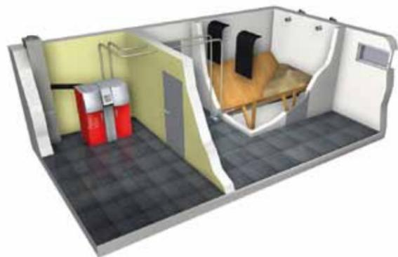
Aujourd'hui il existe des solutions d'appoint de chauffage avec du bois grâce à des poêles à eau situés dans une pièce et pouvant dégager une partie de la chaleur à l'intérieur de cette pièce, la chaleur restante servant alors à alimenter le système de chauffage central.
