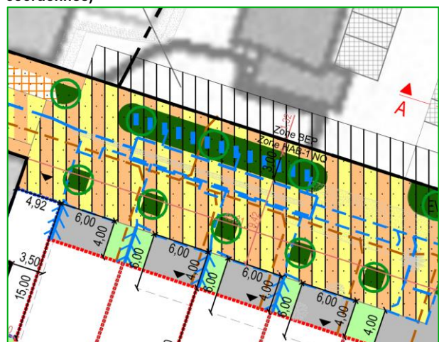
Figure 15: Extrait de la partie graphique de la seconde modification du PAP au niveau du fossé de rétention (version coordonnée)
